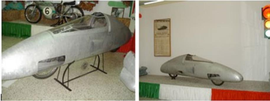
Auf der Rennstrecke von Monza schlägt DEMM 24 Weltrekorde mit einem 50 ccm 2-Takt-Motor, der in ein Chassis mit dem Namen "Siluro" eingebaut ist.
