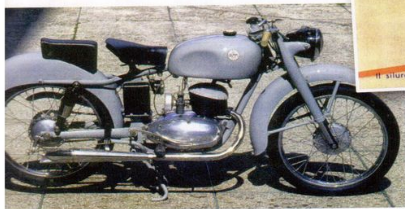
La motoleggera "Turismo" del 1954, equipaggiata con propulsore a due tempi di 125 cm 3 e cambio a 4 velocità. Questo propulsore è in grado di erogare 4,8 CV.
