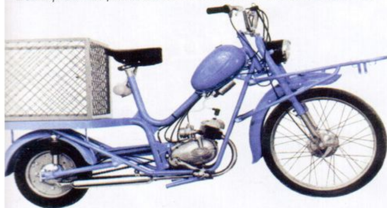
Tra ciclomotori più curiosi prodotti dalla DEMM c'è il "Trasporto", pensato per le consegne cittadine effettuate dai piccoli commercianti. La sua piccola ruota posteriore permetteva di alloggiare il vano di trasporto.
