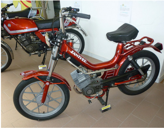
Il ciclomotore Panther del 1979 caratterizzato dal telaio a culla facente funzione di serbatoio per il carburante
