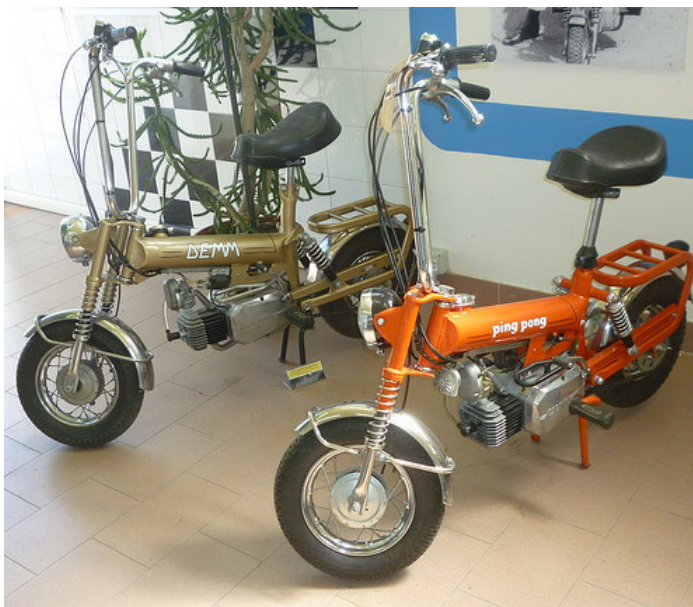
Un paio di esemplari del modello Ping Pong del 1973 facilmente trasportabile nel bagagliaio di un'auto avendo il manubrio e la sella abbassabili
