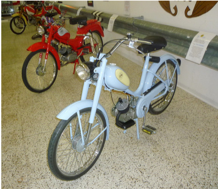
Il Velodemm del 1963 aveva un prezzo contenuto, il motore ha un capacità di 40 cc e la trasmissione é monomarcia
