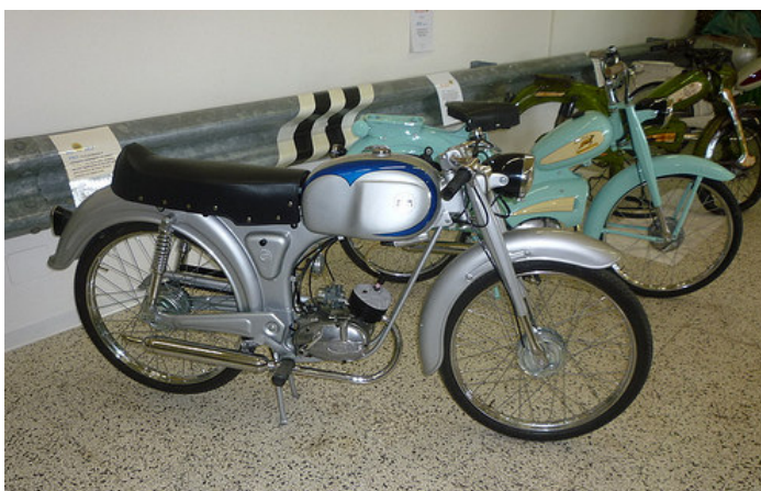
Il ciclomotore Sport Lusso del 1963 con il telaio in acciaio stampato e due tubi nella parte anteriore in modo di sembrare dotato di un telaio a doppia culla. A fianco il ciclomotore Dick Dick Turismo Deluxe caratterizzato dalle apprezzate bandelle coprimotore laterali
