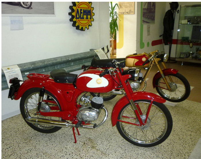
La motoleggera Turismo 75 cc 2 tempi del 1957 con telaio in acciaio stampato
