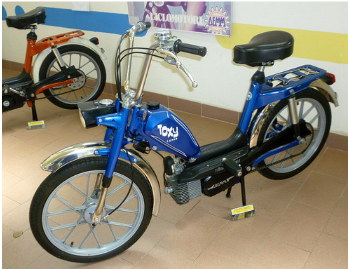
Il ciclomotore Foxy del 1979 destinato al mercato tedesco e caratterizzato dal raffreddamento del motore ad acqua con circuito chiuso
