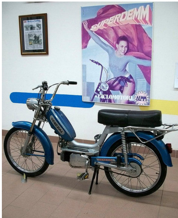
Il ciclomotore General che era stato studiato per essere esportato in Iran. Le modifiche erano state fatte per un utilizzo nel clima di quella nazione caratterizzato da alte temperature di giorno e molto basse di notte
