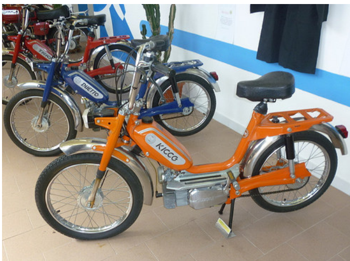
Il ciclomotore Kicco del 1974 con motore monomarcia a frizione automatica
