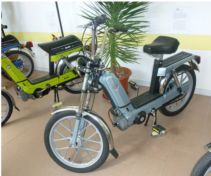
Il ciclomotore Quick 2 del 1980 introdotto pochi anni prima dell'arresto della produzione dei motoveicoli Demm. Era un modello molto efficiente con un cambio automatico a due rapporti e la possibilità di superare delle pendenze superiori al 15%
