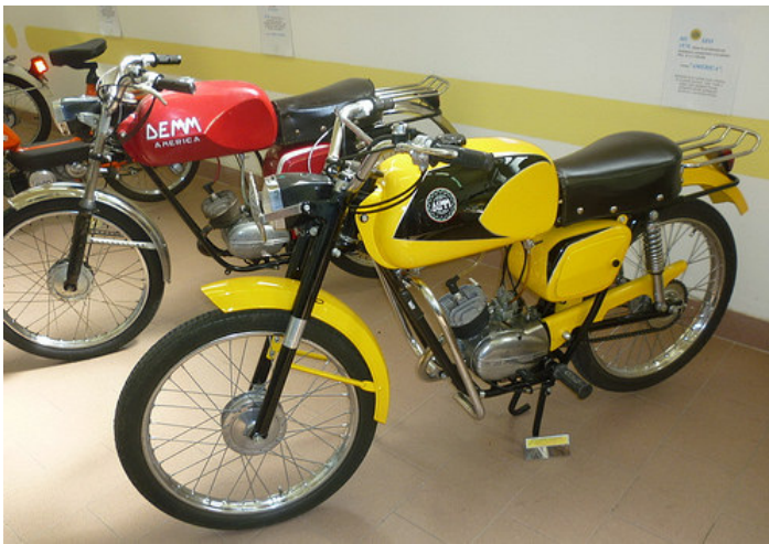
Il modello America del 1970, un motoveicolo di successo, con telaio bitubo a doppia culla, cambio a 3 rapporti, manubrio rialzato, paragambe laterali, portapacchi posteriore e mascherina parasassi sul faro.
