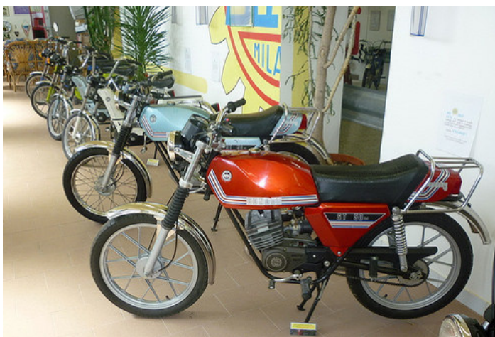
Il ciclomotore sportivo Condor del 1979 con motore monocilindrico a 2 tempi e cambio a 4 rapporti
