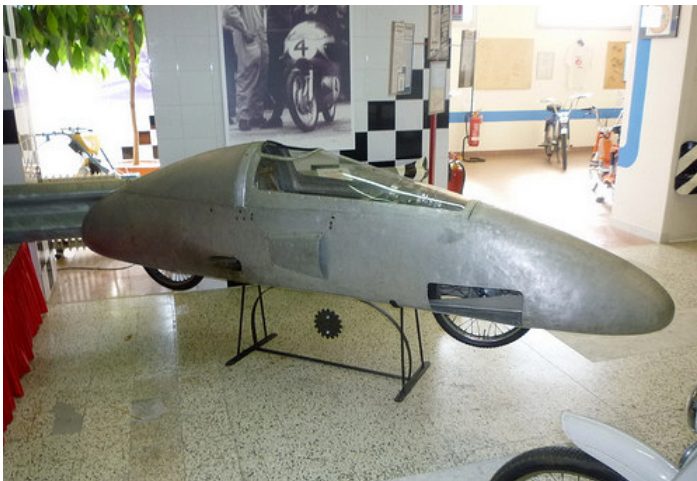
Il ciclomotore da competizione modello "Siluro" del 1956 con motore a 2 tempi di 49 cc che all'autodromo di Monza ottenne 24 record mondiali
