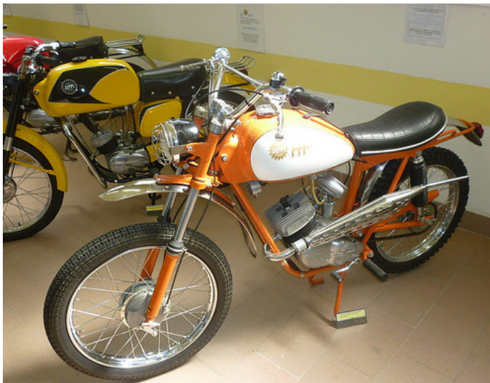
Il ciclomotore Cross HF con cambio a 4 velocità, telaio a doppia culla e forcella telescopica idraulica
