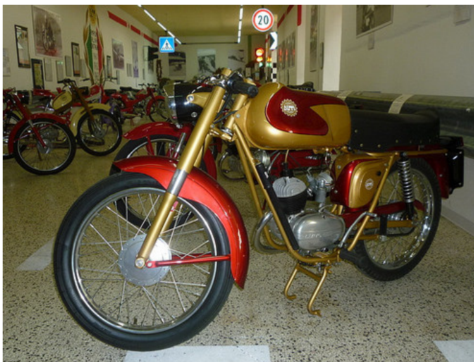
La 75 2 tempi sport del 1959 ha il telaio a doppia culla. La cilindrata di 75 cc permetteva il trasporto di un passeggero
