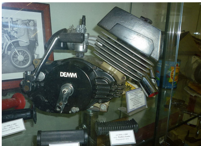
Nella foto il prototipo di un motore a due tempi da competizione con una cilindrata di 49 cc studiato nel 1977 per una fornitura ai clienti privati . Sviluppava un potenza di 11 cv a 12000 giri/minuto e la distribuzione poteva essere sia a valvola rotante che ad aspirazione lamellare
