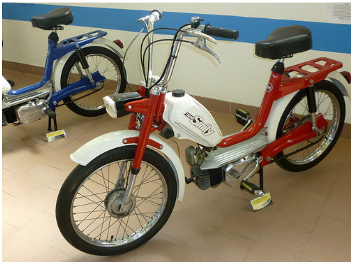
Il ciclomotore Smily del 1972 con motore a 2 tempi orizzontale e pedanine a protezione della parte superiore del motore
