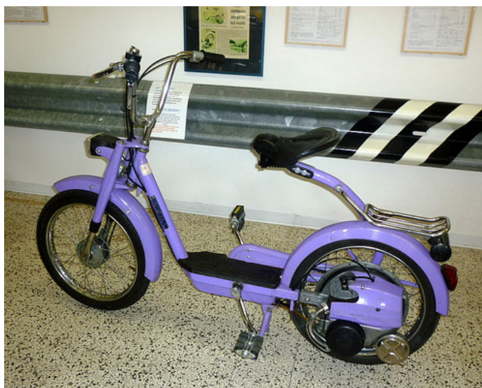
L'originalissimo ciclomotore Mini Demm del 1969 non ebbe successo in quanto il progettista lasciò l'azienda subito dopo la presentazione ed i tecnici rimasti non riuscirono a mettere bene a punto il motoveicolo. Il motore a due tempi con una cilindrata di 40 cc è alloggiato all'interno della ruota posteriore assieme alla trasmissione ad ingranaggi
