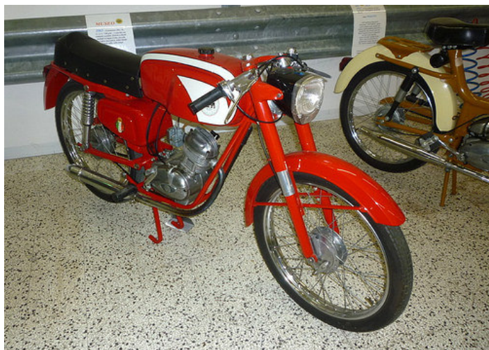
Il ciclomotore Sport Special Lusso del 1965 con telaio a doppia culla e cambio a tre velocità a pedale
