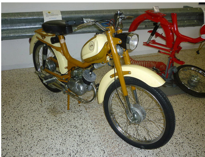
Il ciclomotore Bimatic del 1961 che ha la particolarità di avere un rapporto ridotto inseribile per superare forti pendenze
