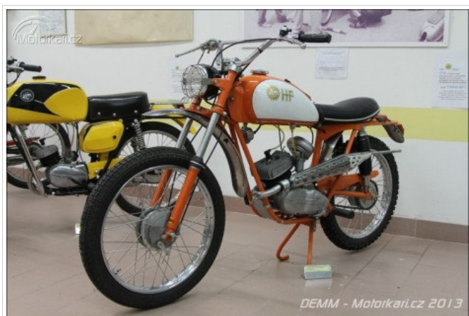
Dvoutaktní terénní padesátka DEMM Cross HF se čtyřrychlostní převodovkou, která se vyráběla od roku 1970.
