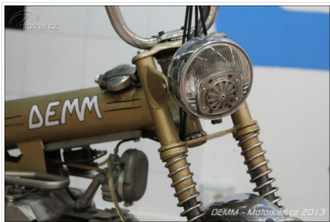
Originální, ale velmi výrobně drahý nápad s integrací klaksonu do skla reflektoru.
